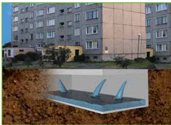
Kelders zijn vaak niet meer aan de buitenzijde bereikbaar. Dus blijft binnenafdichting het enige alternatief.
