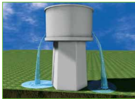
Een volle waterbuffer kan niet aan de binnenzijde worden afgedicht. Zonder het gebruik stop te zetten, wordt de afdichting aan de buitenzijde ( negatieve zijde ) geplaatst.
