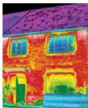
Door enkelwandige muren kan veel warmte verloren gaan.
